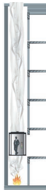
avec ouverture de ventilation vers l'extérieur
